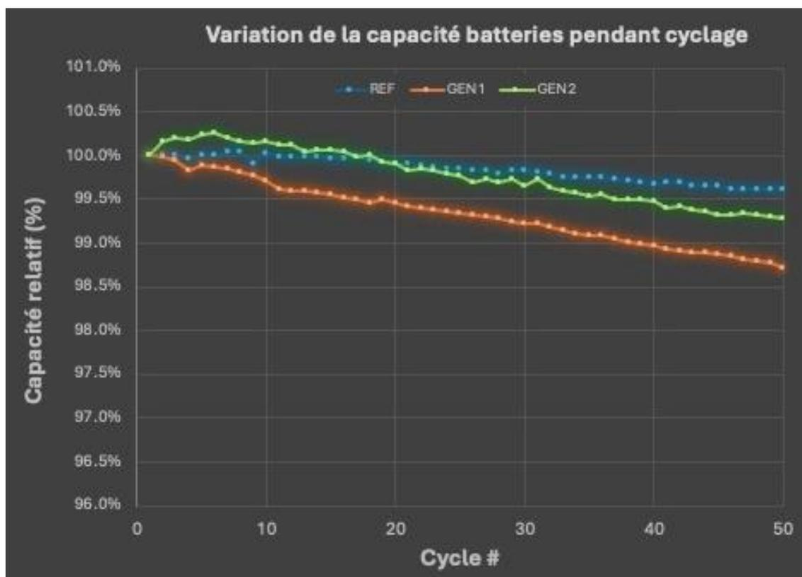
Image 2) La ligne bleue montre la capacité relative des batteries 100 % graphite, la ligne orange montre la capacité relative des batteries GEN1 et la ligne verte montre la capacité relative des batteries GEN2, durant 50 cycles. <sup>[1]</sup>
