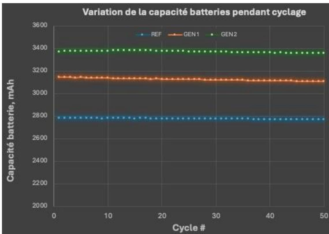
Image 1) La ligne bleue montre la capacité moyenne des batteries 100 % graphite, la ligne orange montre la capacité moyenne des batteries GEN1 et la ligne verte montre la capacité moyenne de GEN 2, toutes mesurées en milliampères-heures (mAh) <sup>[1]</sup>.
