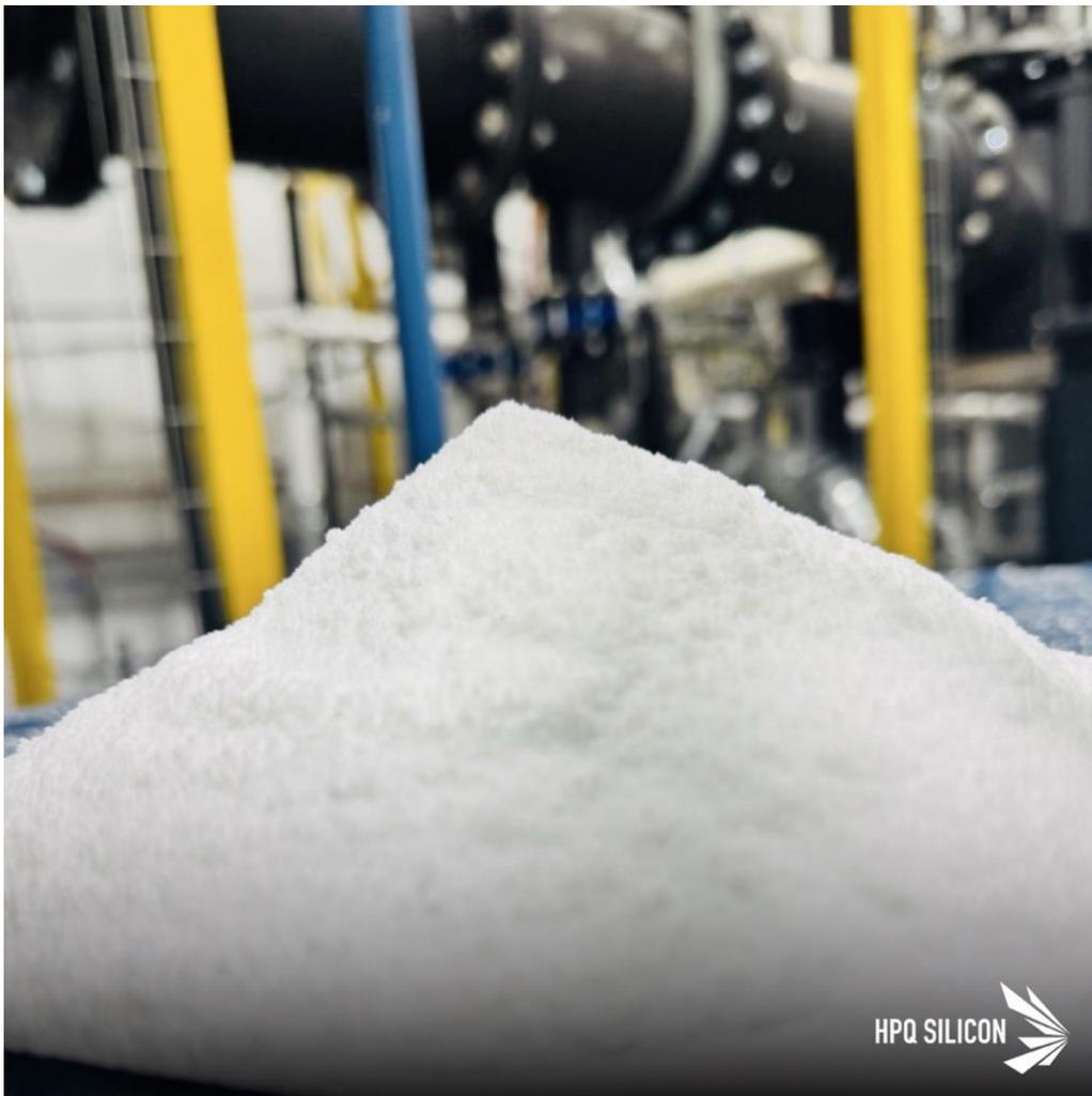
Matériaux obtenus lors de l'essai #6 du réacteur pilote de silice pyrogénée d'HPQ (image fournie par PyroGenesis)
