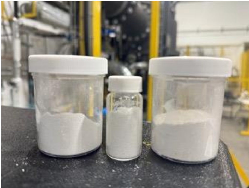
Image : silice pyrogénée, produite par le réacteur de silice pyrogénée.
